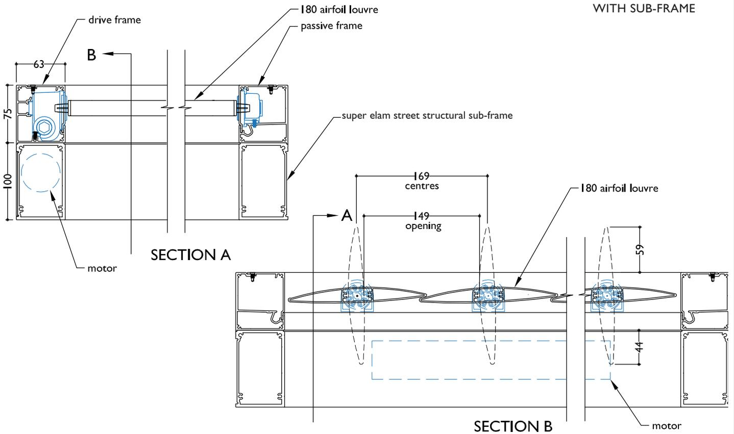
SECTION - MANUALLY OPERABLE 180 AIRFOIL LOUVRE SPIRAL PIVOT
