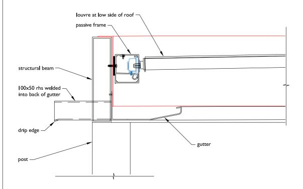
**SECTION - BACK OUTLET IN GUTTER**
